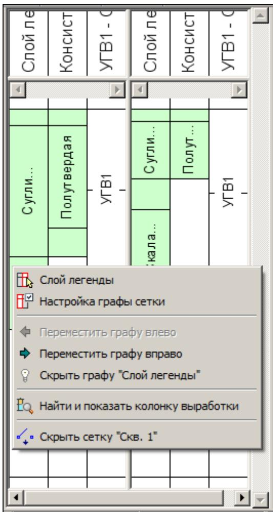
Окно предназначено для последовательного отображения граф проекта сетки выработки, соответствующих слоям проекта с включенной видимостью, и для работы с графиками - ввода и редактирования исходной информации по колонке выработки.
