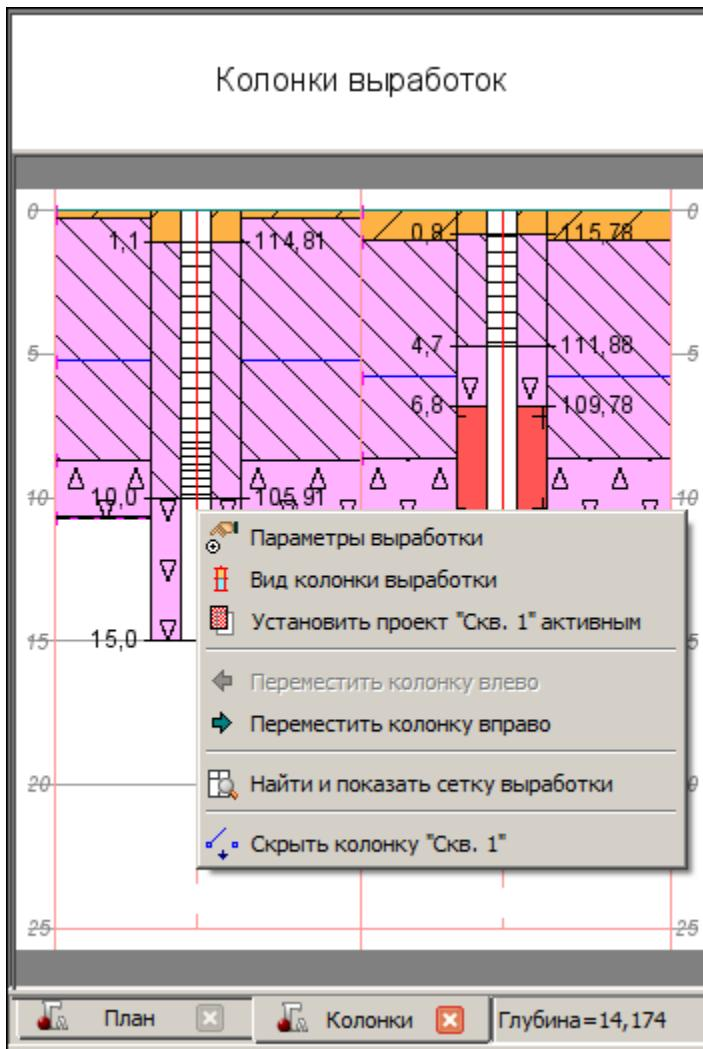
Окно предназначено для графического отображения колонки выработки, а также **Разреза модели** и **Колонки ОГМ** в плановых координатах устья выработки (по настройке).
