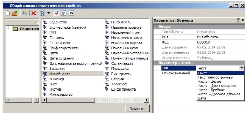
Диалог предназначен для просмотра списка существующих семантических свойств и параметров каждого из свойств, редактирования параметров существующих и создания новых семантических свойств, присвоения свойствам одного или нескольких значений.
