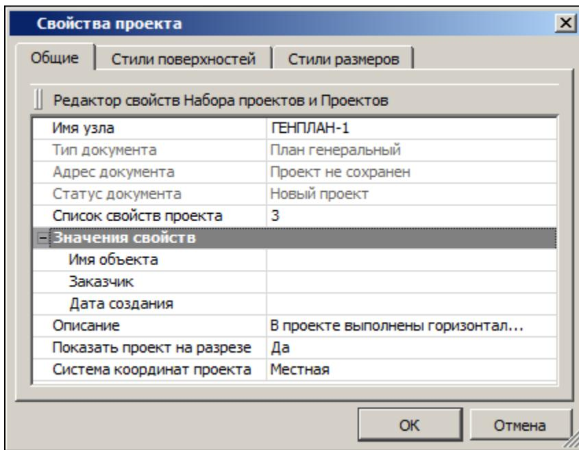
Для пополнения списка семантических свойств проекта служит кнопка **Редактор свойств Набора проектов и Проектов**, которая вызывает диалог [Общий список семантических свойств](#).
