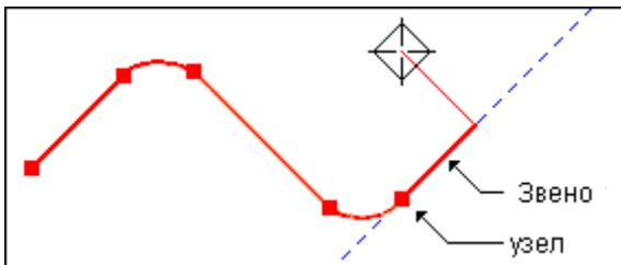
При построении модельных элементов полилинии создаются автоматически. Если на полилиинии создан модельный элемент, то она станет «несвободной» и невидимой. Как результат, некоторые действия по редактированию такой полилинии будут уже невозможны.
