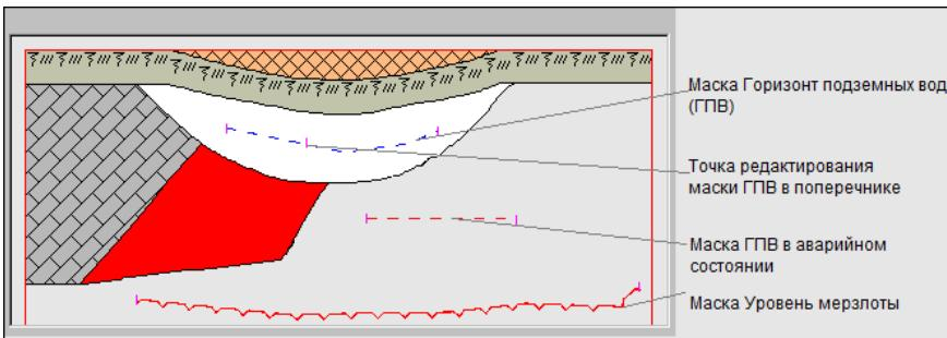
За внешний вид масок отвечают объекты геологического классификатора **Горизонт подземных вод** и **Уровень мерзлоты**. Аварийное состояние у маски возникает, если она имеет указатель на несуществующий объект геологического классификатора.
