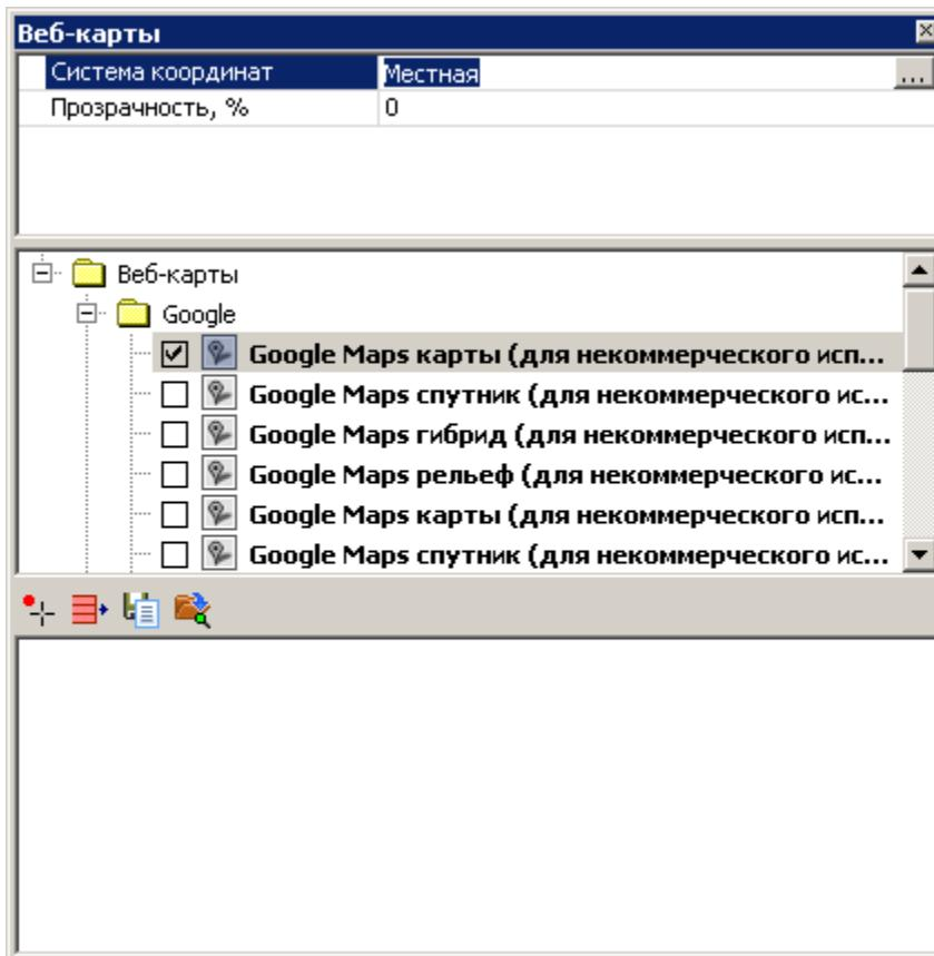
Панель состоит из окна параметров (верхняя часть), дерева источников веб-карт (средняя часть) и таблицы с инструментами для дополнительной интерактивной трансформации карт по совмещенным точкам.
