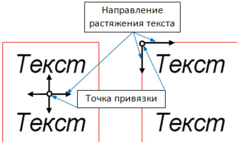
При необходимости текст можно растянуть или сжать. Для этого служат параметры: **Коэффициент растяжения** многострочного текста, **Интервал между буквами** одностороннего текста.
