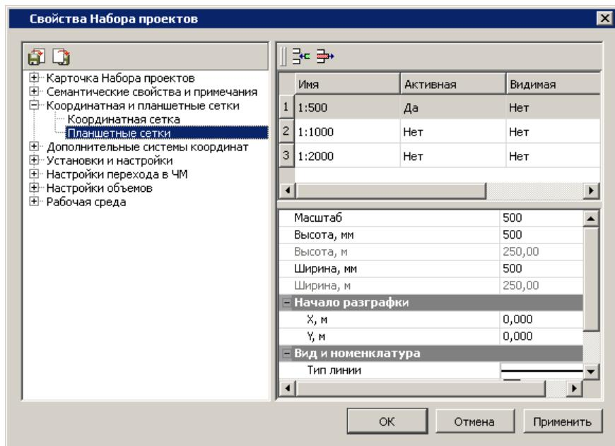
Нанесенная на план планшетная сетка поможет визуально установить местоположение объекта в структуре планшетов соответствующих масштабов и указать планшеты для дальнейшей передачи данных в чертежную модель.
