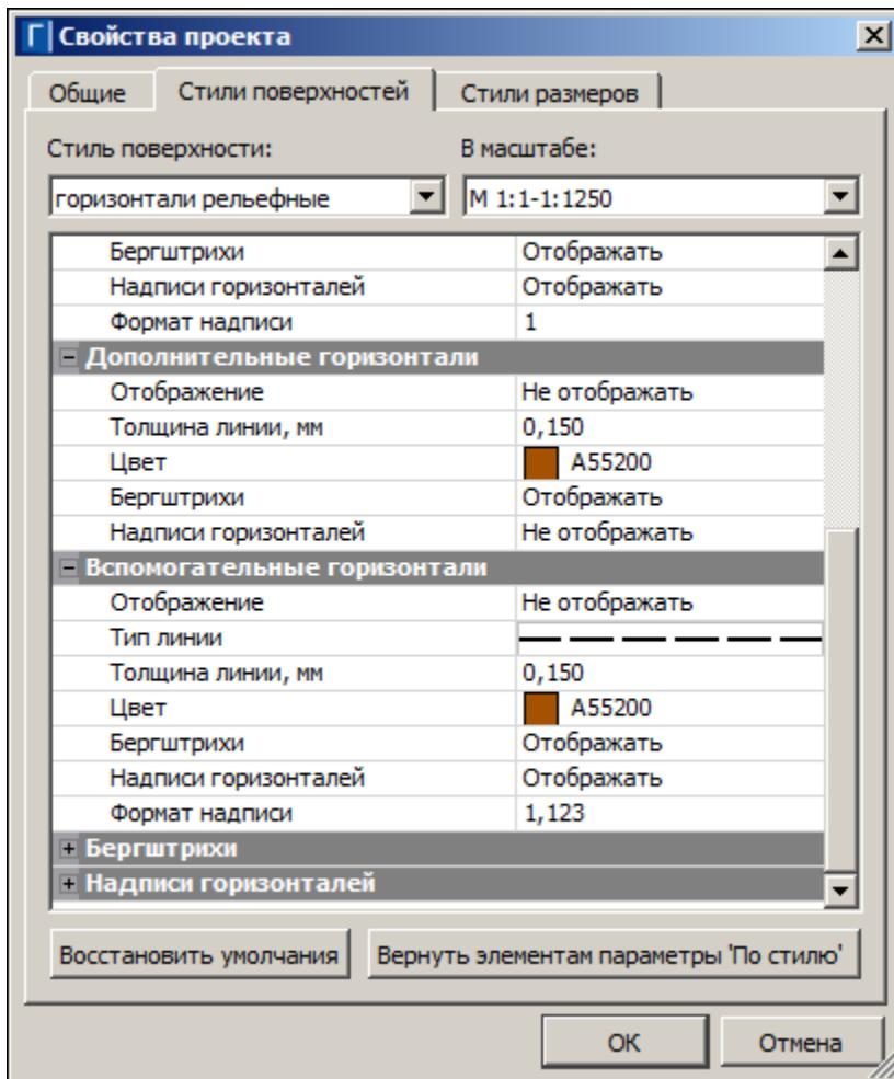
Чтобы настроить параметры определенного стиля, необходимо выбрать его имя из списка **Стиль поверхности**, а также выбрать масштабный ряд в параметре **В масштабе**. Набор параметров различен для разных стилей.
