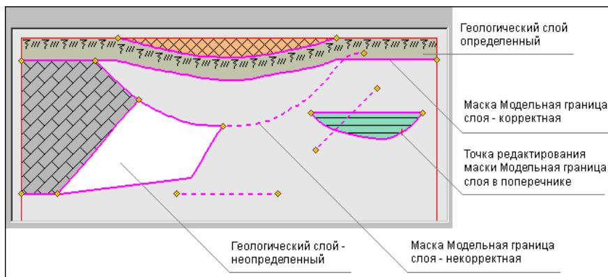
Маски МГС хранятся в служебном слое *Модельные границы* проектов **Геология на профиле**, **Разрез ОГМ**, **Геология полосы** и **Геология на поперечнике**.
