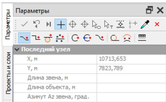
Состоит из **локальной панели инструментов** с кнопками управления построением и **окна параметров** со списком параметров, которыми пользователь оперирует в процессе работы с элементами модели, а также **дополнительной локальной панели инструментов** с кнопками вызова методов команды.
