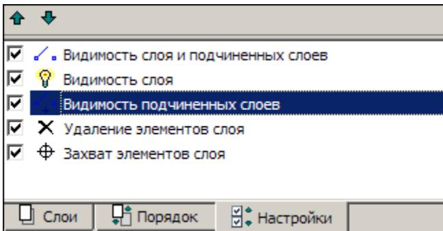
**Вкладка Порядок** - представлен список всех слоев проекта и их номера. Порядок их расположения в этом списке влияет на последовательность их отрисовки (напложения) в рабочем окне. Отрисовка слоев производится программой согласно порядковым номерам списка: первым отрисовывается слой №1 (верхний в списке), затем "накладывается" слой №2 и т. д., самым последним отрисовывается слой с самым большим номером (нижний в списке). Таким образом, чем ниже слой в списке, тем выше находится "пленка" слоя.
