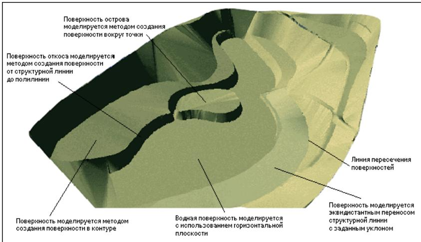
Одновременная настройка стилей отображения проектных поверхностей - редактирование стилей позволяет легко изменить вид отображения участка, например, условным знаком откоса, выбрать метод проведения горизонталей, уменьшить или увеличить шаг горизонталей или вообще не отображать их.
